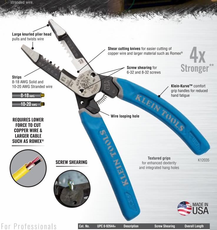
SHEAR-CUT HEAVY-DUTY WIRE STRIPPER
